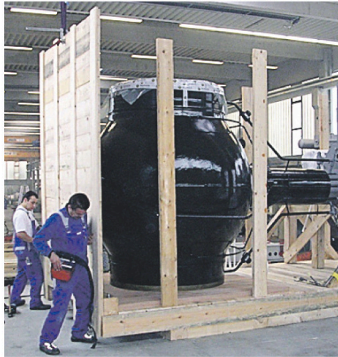
Vor-Ort-Verpackung eines 25 Tonnen schweren Spezialventiles durch ein Verpackungsteam der IVH.
